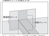
③透湿防水シートを被せ、シールドコーナーAを取付ける ④シールドコーナーAを防水処理して完了
