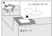
③シールドコーナーBをタッカーで仮留めし、防水テープで処理する ④取合い部を防水処理して完了
