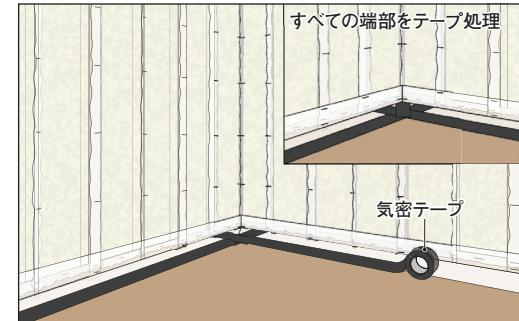
④壁側の本製品を断熱材へテープ処理し完了
