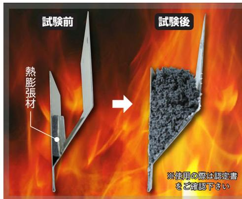
↑火災発生時、熱膨張材が小屋裏への延焼を防ぐ
