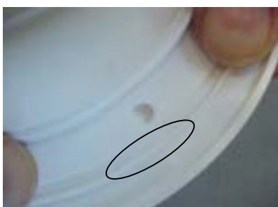
でセットするした本体と2枚のプレートは溝からズレない様にしっかりと持っておきます
