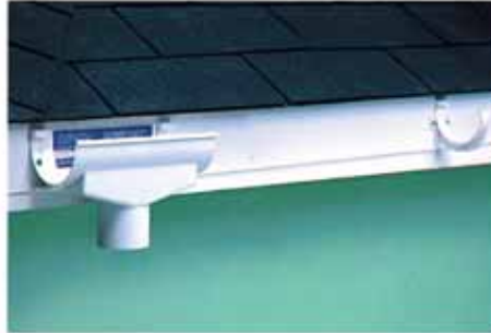
②ブラケットは455mmピッチです。じょうごの位置を確認して下さい。
